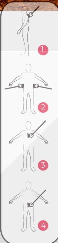
(1) La argolla dorsal se utiliza en sistema anticaídas o restrictivo, (2) las laterales para posicionamiento, (3) la esternal para uso con sistemas anticaídas verticales, (4) la argolla ventral puede utilizarse para sujetar un descensor, cintas de posicionamiento o cintas de progresión.
